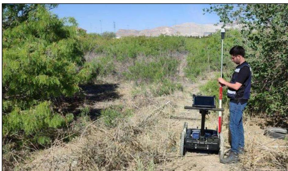
*Figura 29. Fotografía de medición con GPS RTK en trayectoria de exploración de georradar.*
