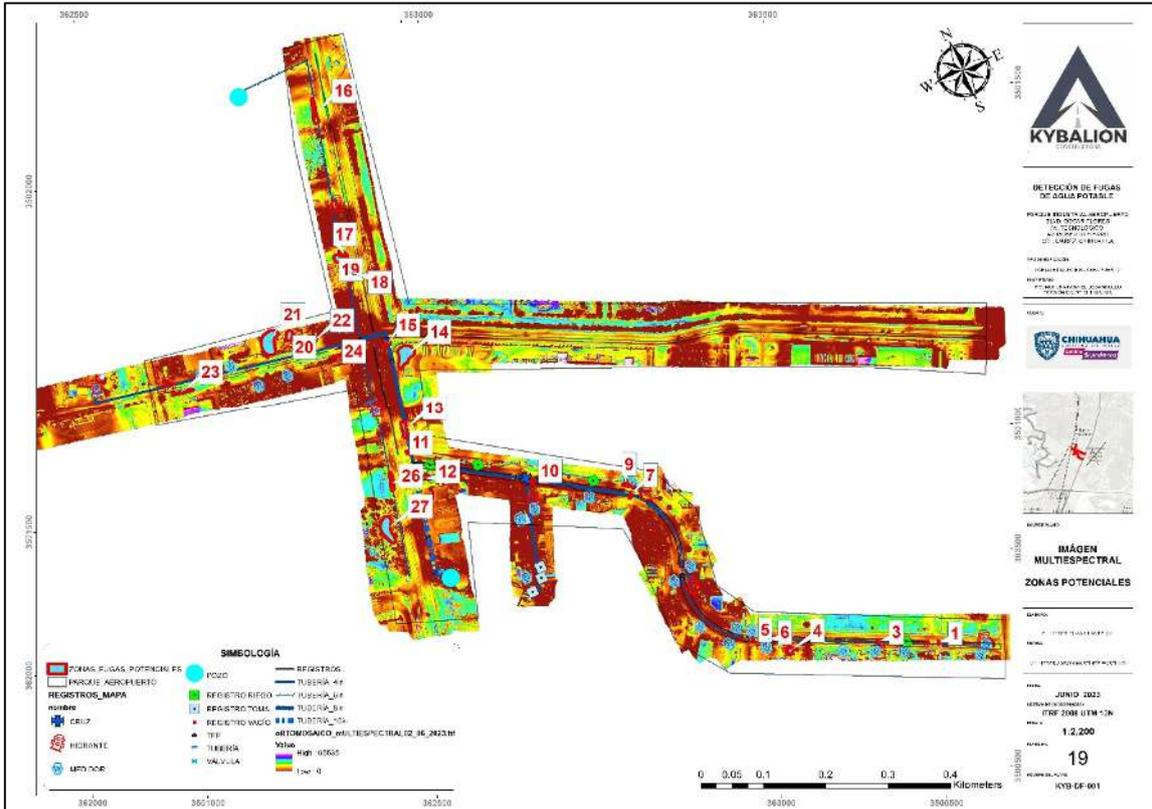
Figura 41. Análisis multispectral para detección de fugas potenciales.
