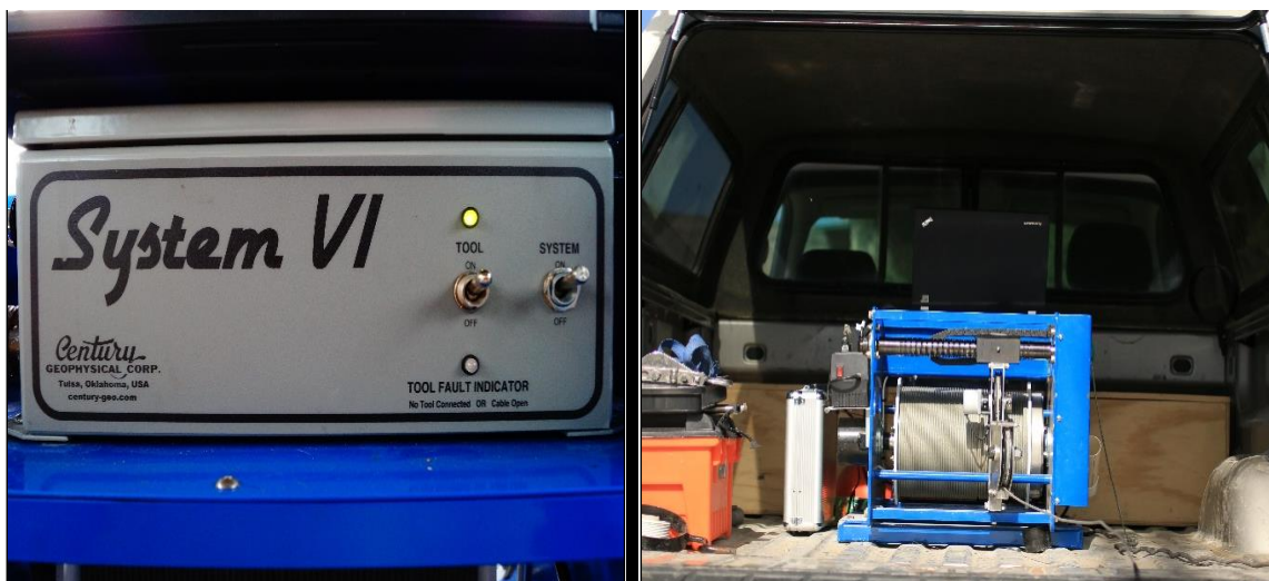
Fotografía No. 1: Equipo utilizado para la ejecución del Registro Geofísico de pozo: sonda Modelo 9144, Marca Century Geophysical Corporation.
