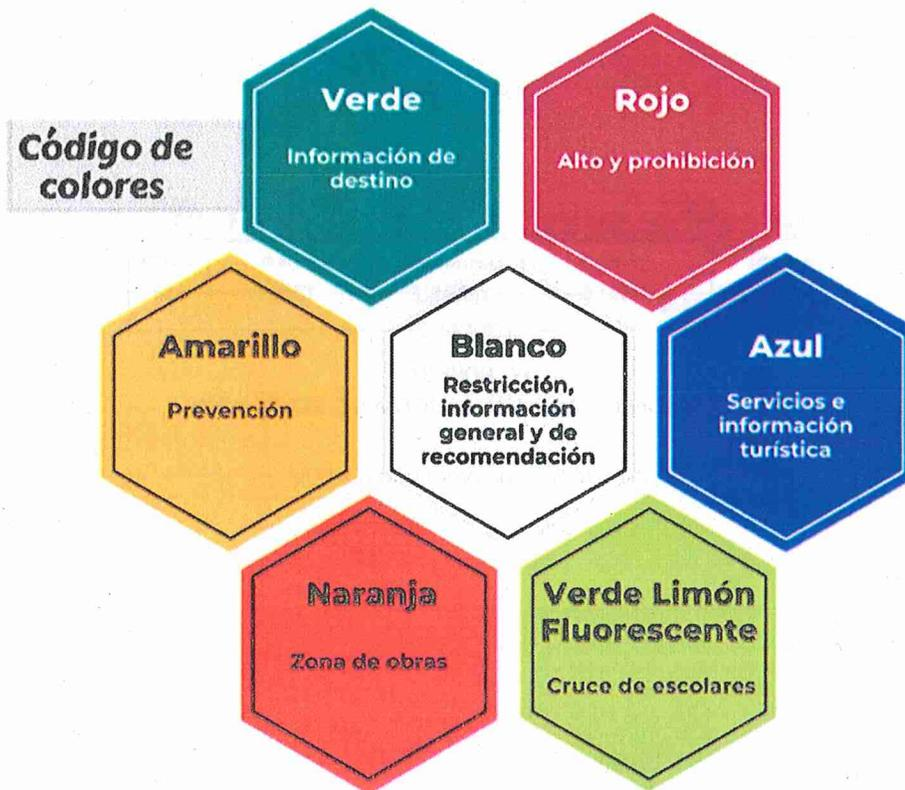
IMG. 17. Código de color para señalamientos viales del Manual de señalización vial y dispositivos de seguridad. SCT.
