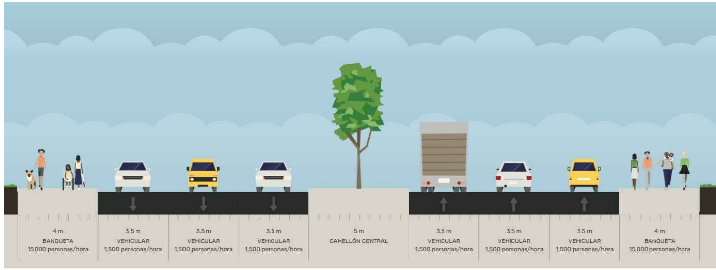
SECCION TIPO PP-132 AV. ORIENTE AEROPUERTO
